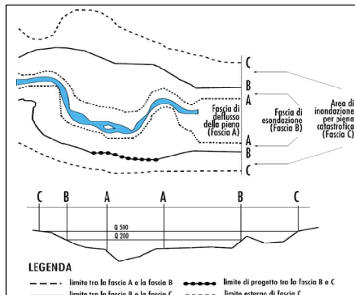
Figura 4.2 - Schema per la delimitazione delle fasce fluviali.
