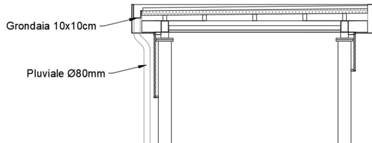
Figura 8.2: Dettagli idraulici pensilina ricovero bici.
