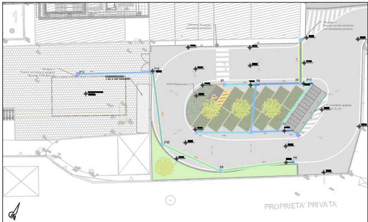
Figura 7.1 - Sistema di drenaggio.
