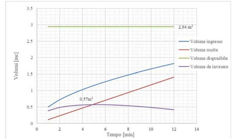
L'area in oggetto ha una superficie di 19.6 m<sup>2</sup>, considerando una profondità di 0.15m si ottiene un volume di 2.94 m<sup>3</sup>. Il coefficiente di sicurezza del sistema è di 5.14.
