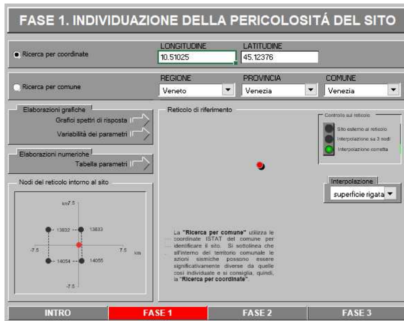
Figura 6-23 - Definizione dell'azione sismica, Fase 1
