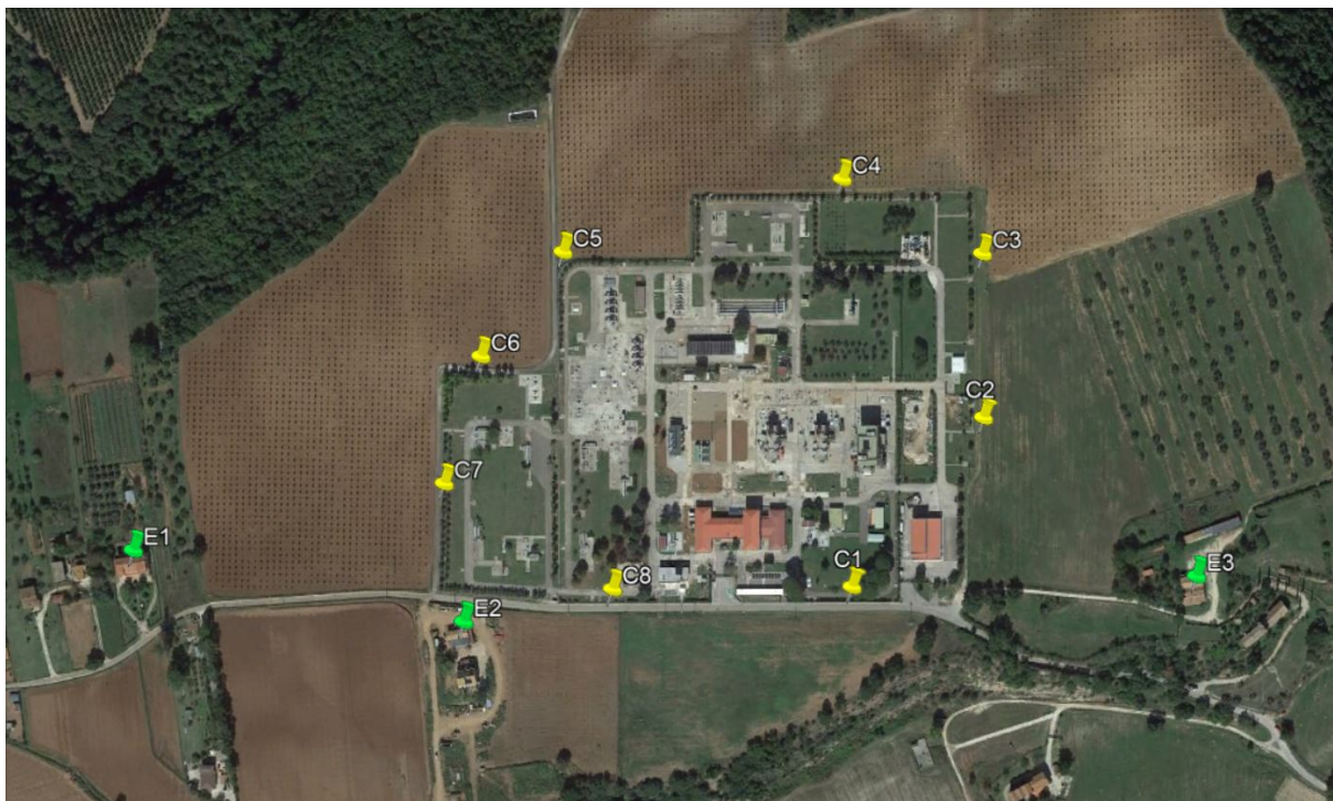
Fig. 3.1 – Ubicazione dei punti di misura al confine (C) e dei ricettori (E)
