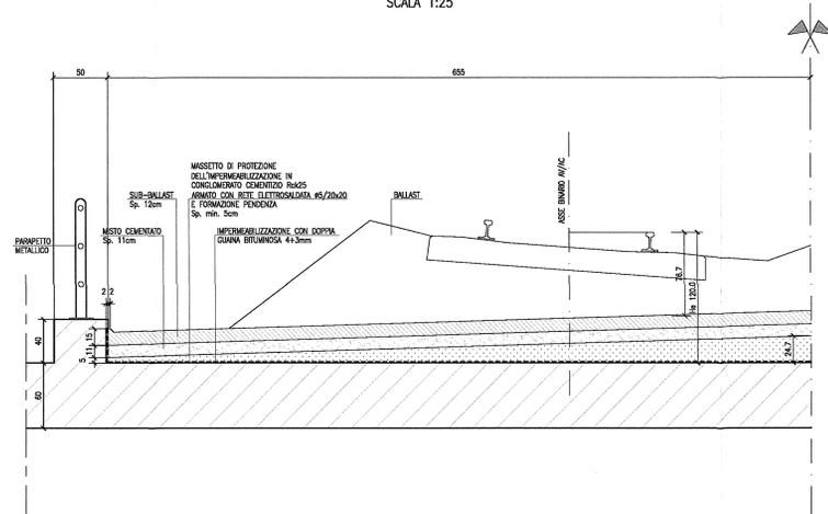
SEZIONE TIPO VIABILITÀ IN RILEVATO
