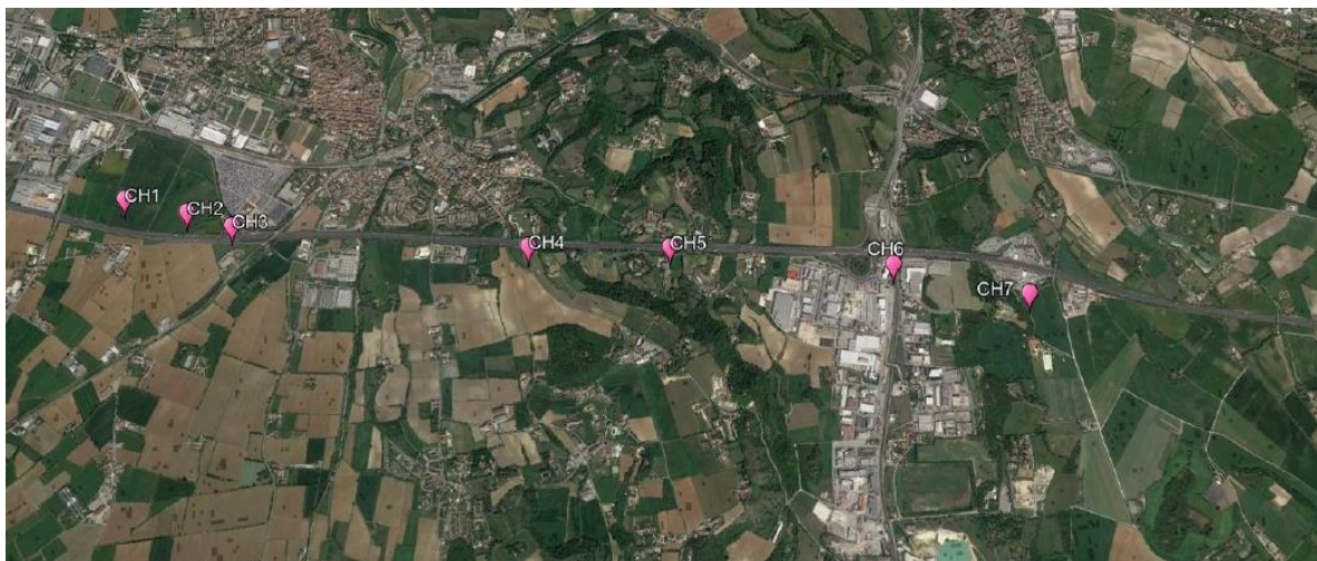
Figura 5.1 – Campagna geognostica integrativa 2017 per la progettazione esecutiva; ubicazione delle coppie di fori di indagine.
