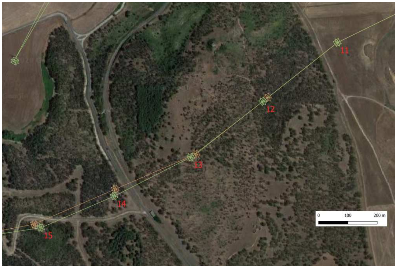
Figura 2-7. Dettaglio dello spostamento sostegni tratta 11-15. In colore verde il progetto esecutivo, in colore arancione il progetto autorizzato.
