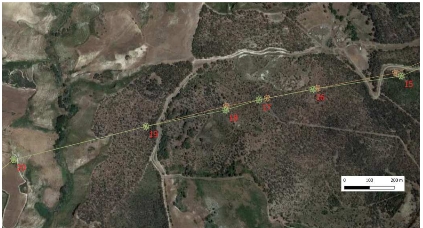
Figura 2-8. Dettaglio spostamento sostegni tratta 15-20. In colore verde il progetto esecutivo, in colore arancione il progetto autorizzato.
