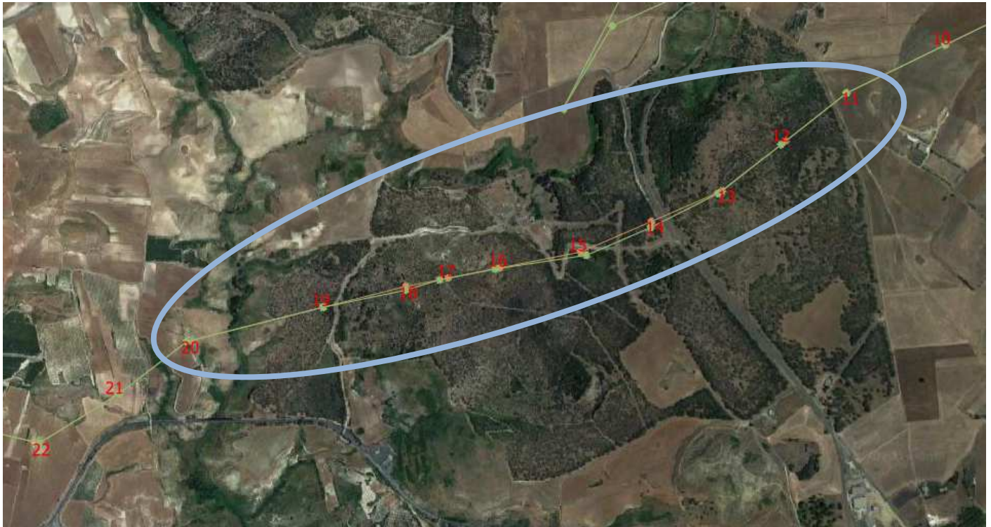
Figura 2-6 Individuazione del tratto oggetto di ottimizzazione (intervento 4; sostegno 11-19). In colore verde il progetto esecutivo, in colore arancione il progetto autorizzato
