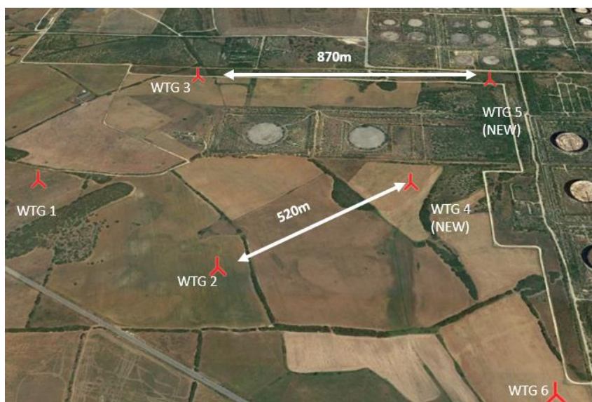
Figura 8: Ipotetico layout che rispetta le interdistanza suggerite dalle Linee Guida
