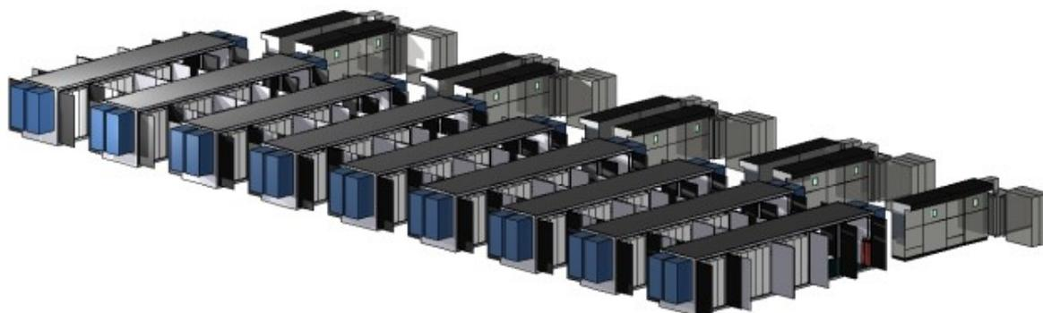
La composizione del BESS, da un punto di vista elettrico, sarà modulare, ovvero saranno previste 5 sezioni, quattro delle quali dotata di n.4 inverter con una potenza attiva nominale pari a circa 5,56 MW (cos phi: +/-0.9) e di n.30 rack batterie con una capacità di circa 6,442 MWh (Inizio vita) e 1 dotato di n.2 inverter con una potenza attiva nominale pari a circa 2,78 MW (cos phi: +/-0.9) e di n.10 rack batterie con una capacità di circa 3,221 MWh (Inizio vita).
