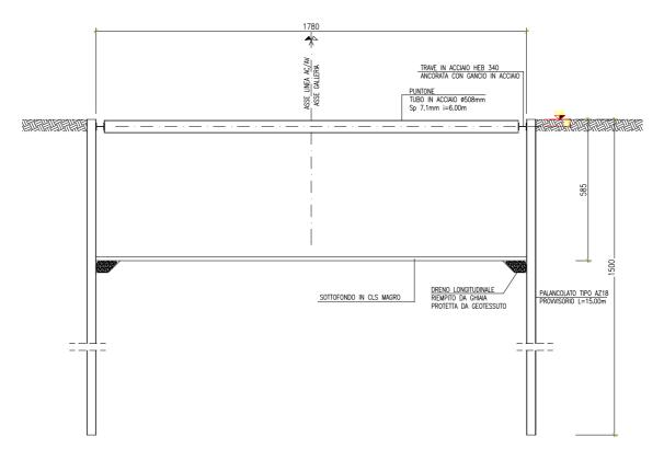
La struttura è quindi realizzata mediante l'infissione, da un piano di prescavo uniforme, di una doppia paratia ai due lati della galleria artificiale.
