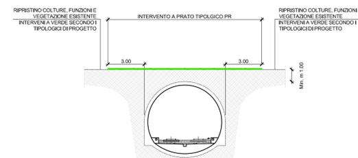
SEZIONE CON GALLERIA ARTIFICIALE SCATOLARE - scala 1:200
