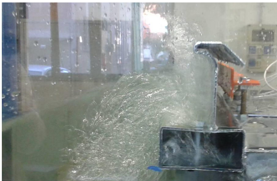
Figura 21 – Test su modello fisico di opera foranea a paramento verticale con muro paraonde arretrato.
