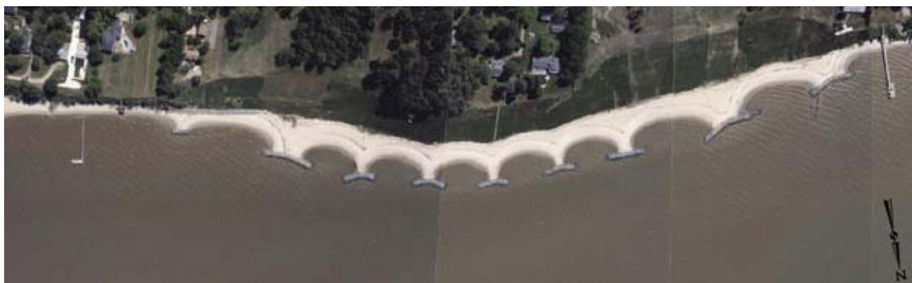
Figura 6: Esempio di protezione di un litorale con scogliere parallele
