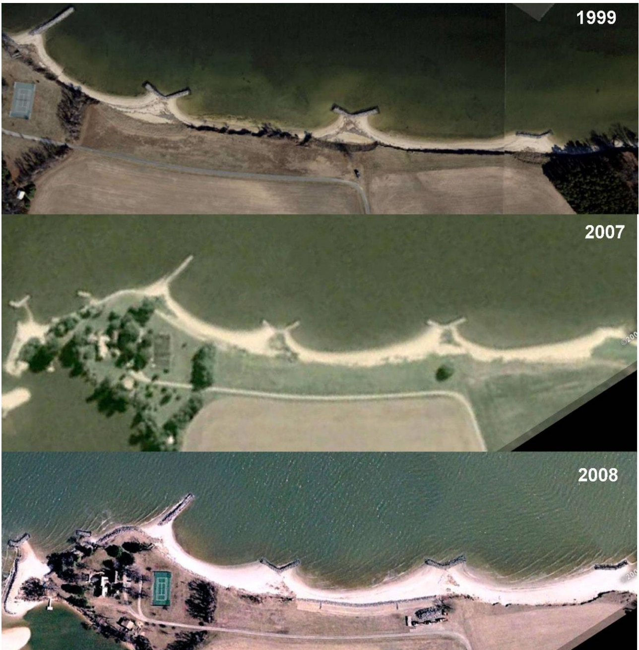
Figura 7: Esempio dell'evoluzione di un litorale protetto da scogliere emerse simili a quelle in progetto
