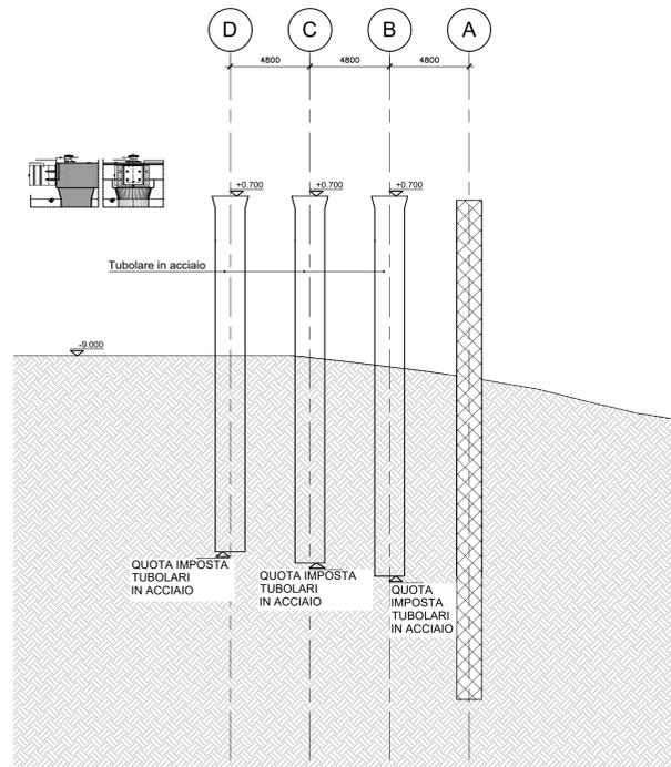
4. Filo B/C/D: Esecuzione pali portanti in c.a. Ø1800mm fino a quota progetto;
