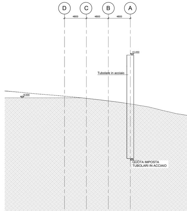
2. Filo A: esecuzione pali portanti in c.a. diametro 1500mm fino a quota progetto;
