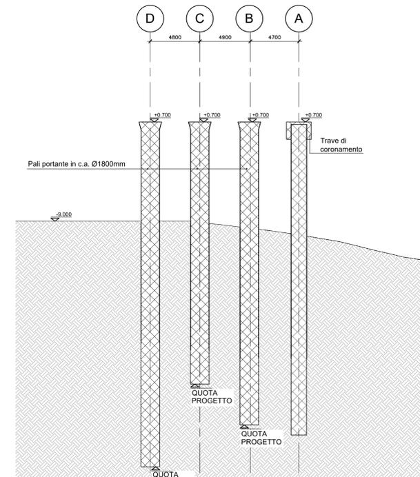
6. Realizzazione trave in c.a. sezione 2500x500mm da quota +0.70 a +1.20m slmm
