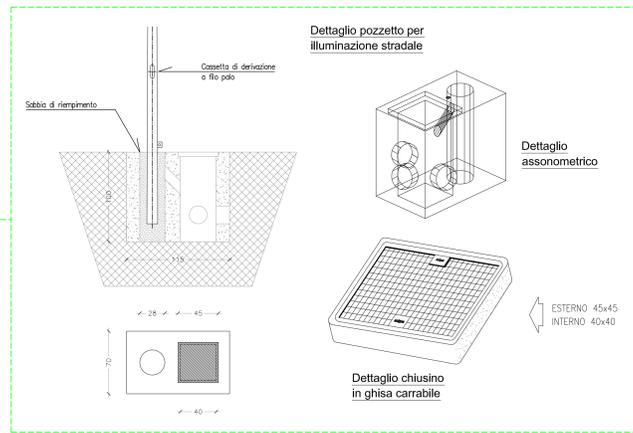
Dettaglio pozzetto per illuminazione stradale
