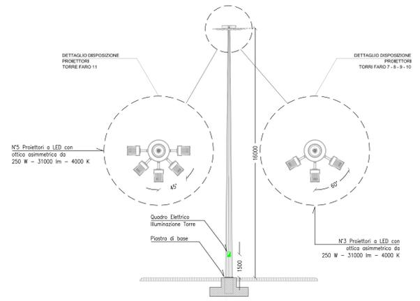
DETTAGLIO DISPOSIZIONE PROIETTORI TORRE FARO 11
