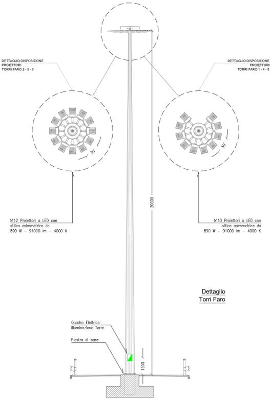
DETTAGLIO DISPOSIZIONE PROIETTORI TORRE FARO 2 - 3 - 6
