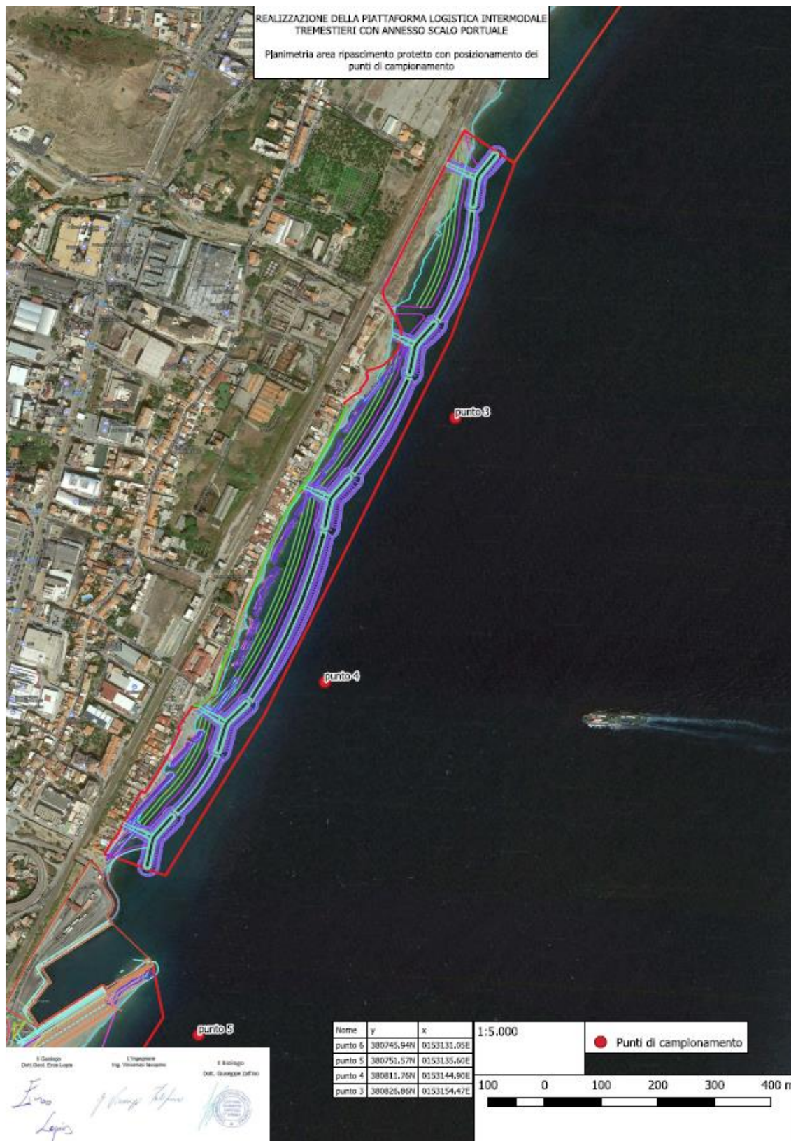
Figura 5 - estratto planimetrico con ubicazione dei punti di campionamento per acque di mare e mitili
