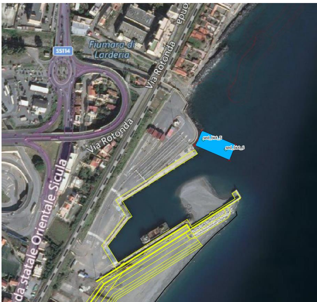
Figura 8 - estratto planimetrico del posizionamento del transetto da cui sono stati prelevati 3 campioni di sedimento (5m da costa, 15m da costa, 30m da costa)
