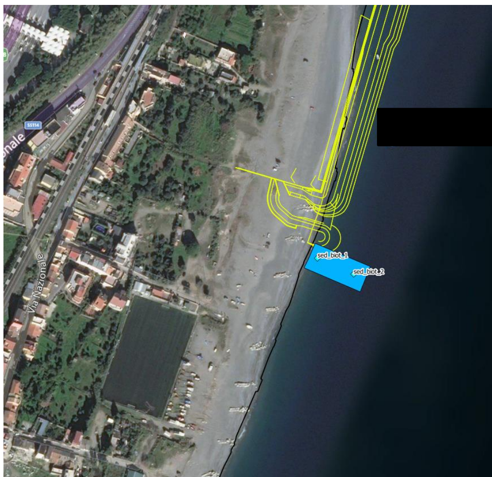
Figura 9 - estratto planimetrico del posizionamento del transetto da cui sono stati prelevati 3 campioni di sedimento (5m da costa, 15m da costa, 30m da costa)
