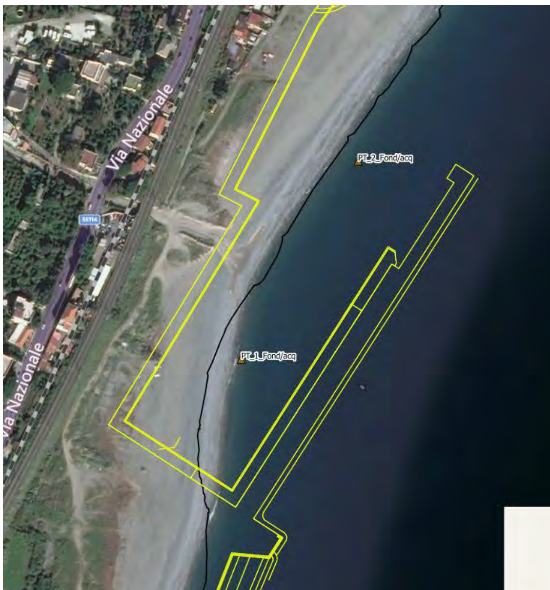
Figura 10 - stralcio planimetrico raffigurante i punti di prelievo dei fanghi del fondale e delle acque all'interno della darsena
