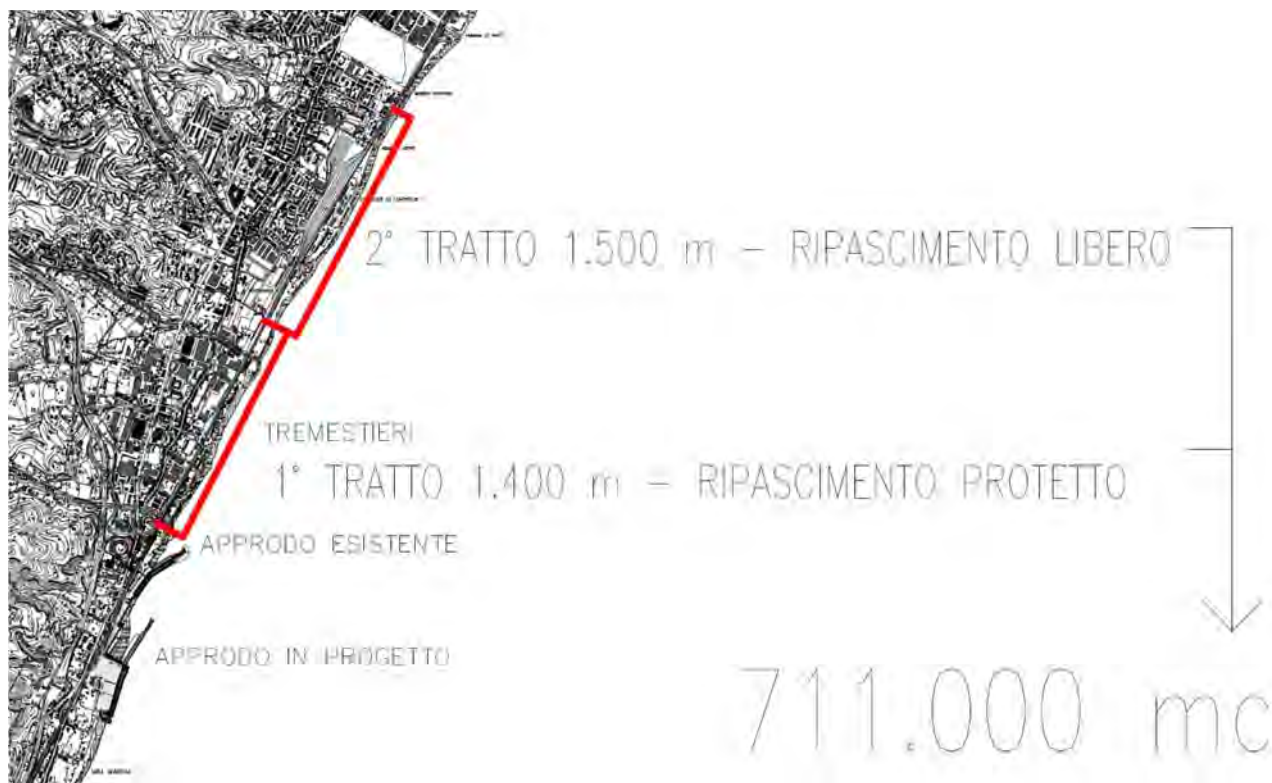
Figura 4 – corografia dell’area di progetto, a sud la nuova realizzazione, in rosso le aree dove si effettuerà il ripascimento
