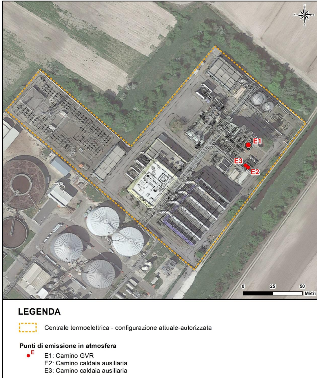
Figura 3.1.3.1a Localizzazione camini della Centrale nella configurazione autorizzata AIA
