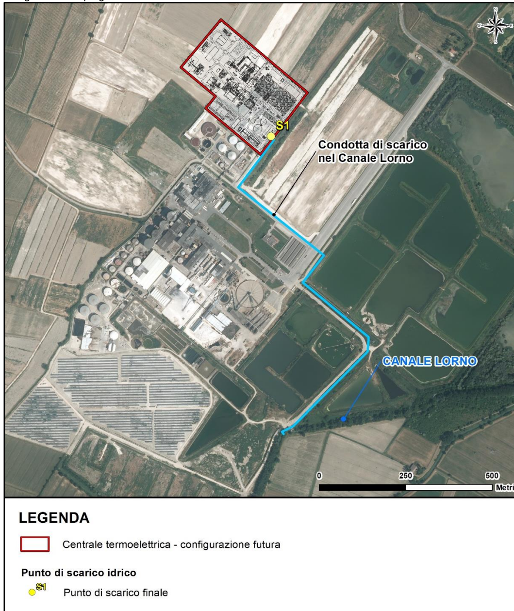
Figura 3.2.3.2a Localizzazione scarico S1 e condotta di scarico esistente nel canale Lorno della Centrale nella configurazione di progetto
