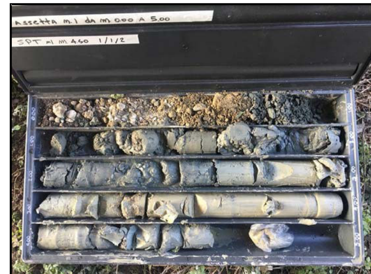
Foto n.20: SN2 - Dettaglio Cassetta 1 da 0,0 a 5,0 m
