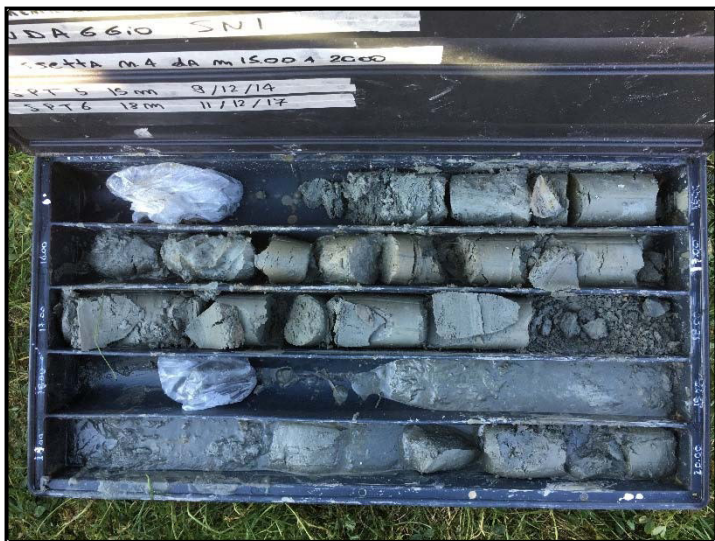
Foto n.9: SN1 - Dettaglio Cassetta 4 da 15,0 a 20,0 m
