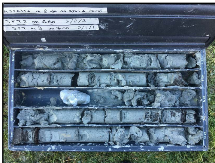
Foto n.5: SN1 - Dettaglio Cassetta 2 da 5,0 a 10,0 m
