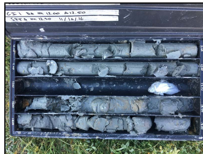
Foto n.7: SN1 - Dettaglio Cassetta 3 da 10,0 a 15,0 m
