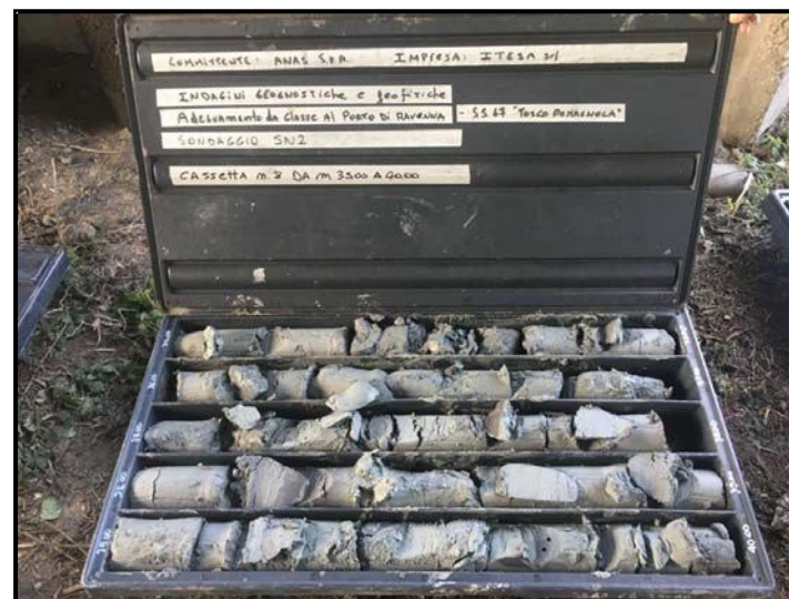
Foto n.32: SN2 - Dettaglio Cassetta 7 da 30,0 a 35,0 m
