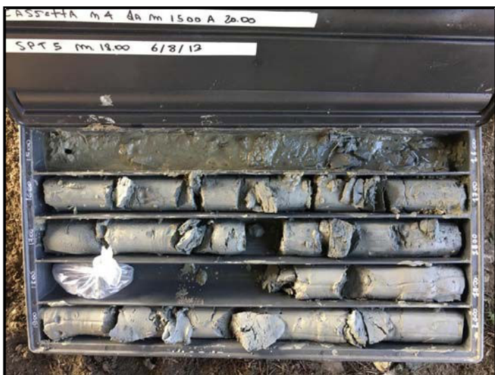
Foto n.26: SN2 - Dettaglio Cassetta 4 da 15,0 a 20,0 m
