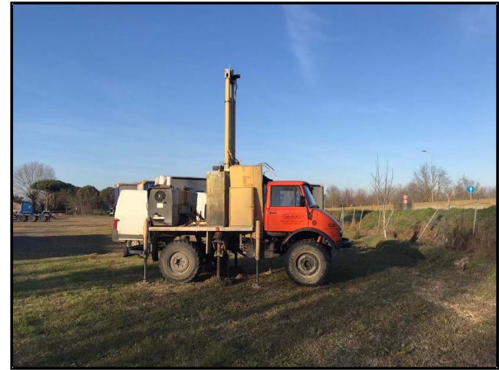
Foto n.37: Esecuzione prova CPTU3
