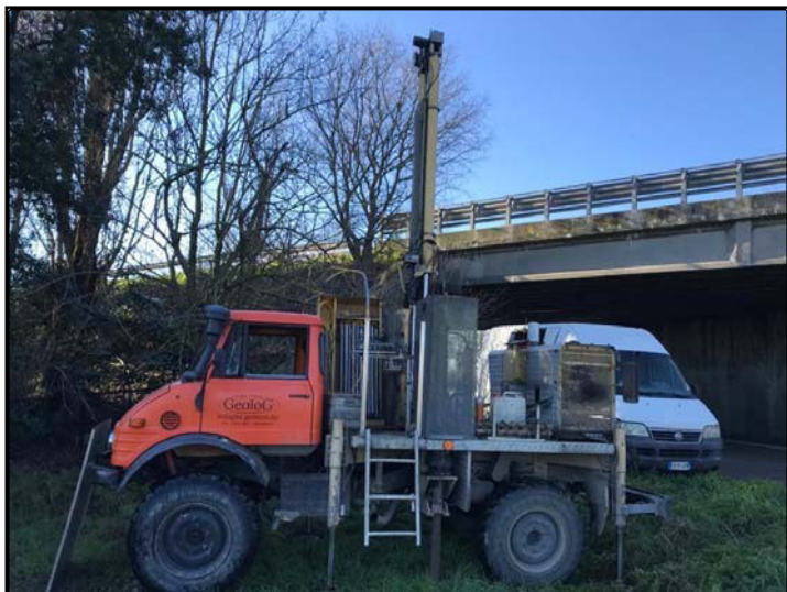
Foto n.39: Esecuzione prova CPTU5
