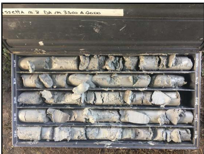
Foto n.34: SN2 - Dettaglio Cassetta 8 da 35,0 a 40,0 m
