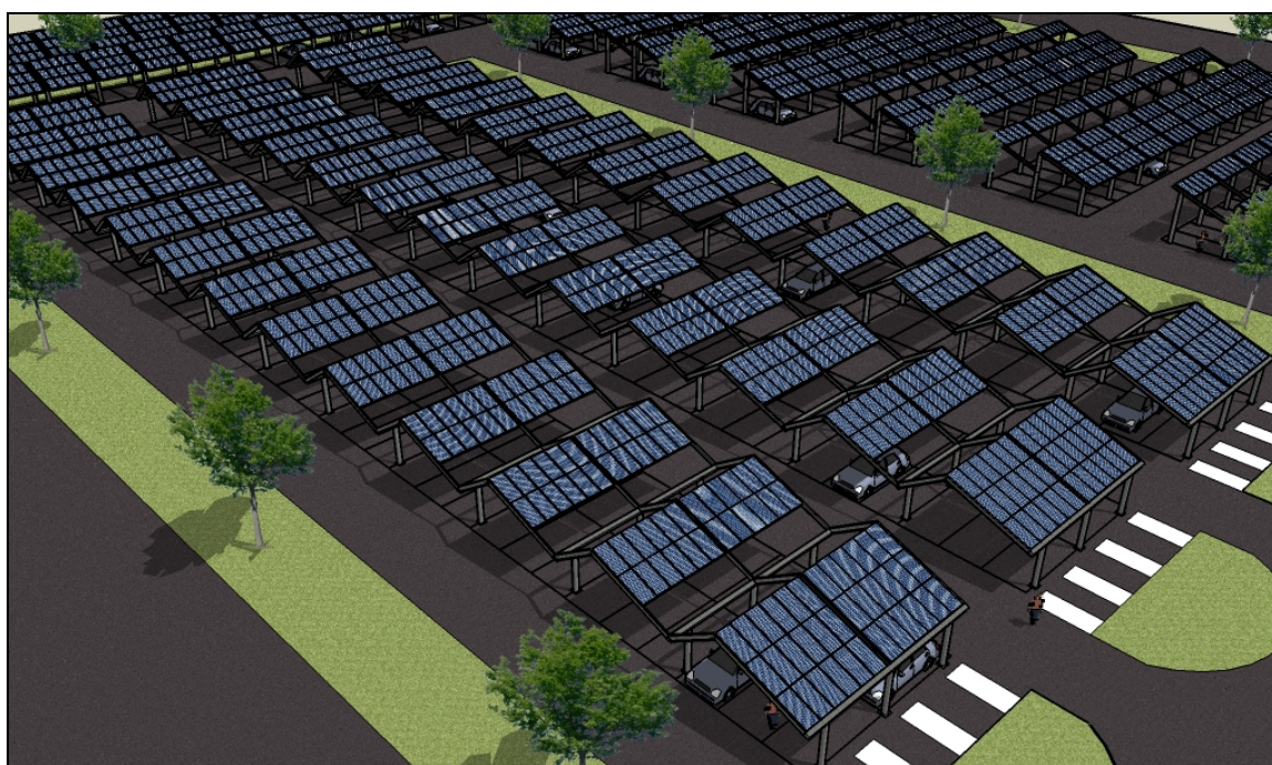
Figura 6-16 Layout pannelli fotovoltaici su parcheggio Lunga sosta
