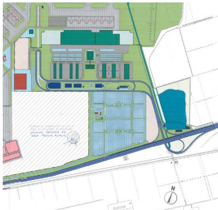
Figura 5-13 Svincolo in uscita dall'area Cargo city/lunga sosta da Stralcio Piano di sviluppo 1995
