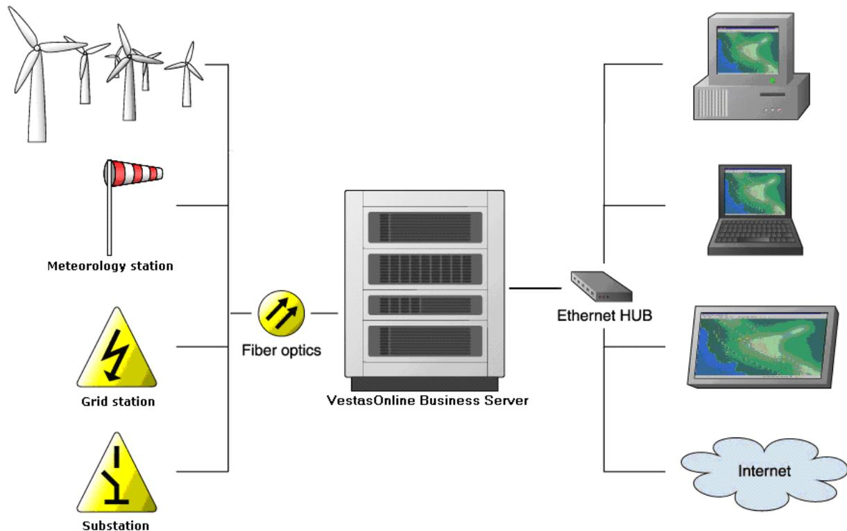
Figura. 2 schema Sistema SCADA
