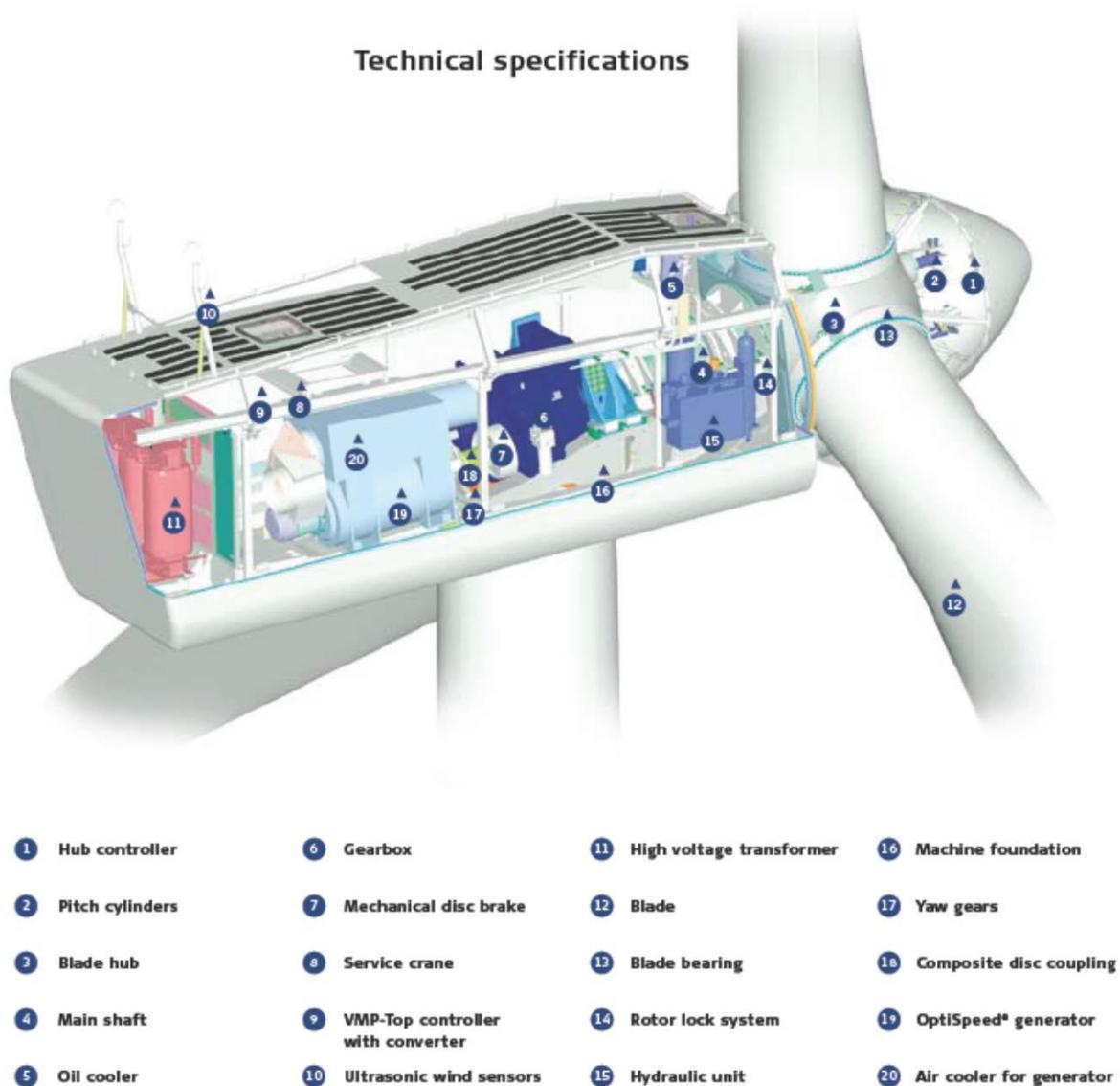
Figura. 1 schema descrittivo aerogeneratore
