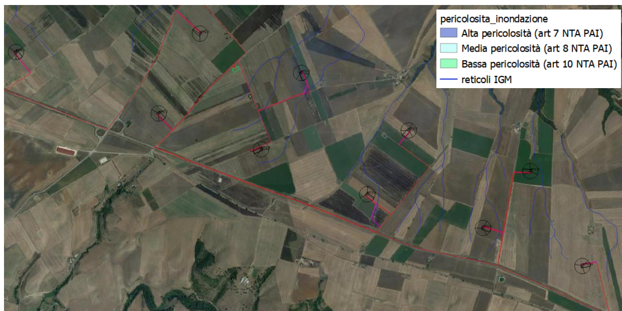
Inquadramento intervento su ortofoto rispetto le aree a diversa pericolosità idraulica riportate nel PAI vigente
