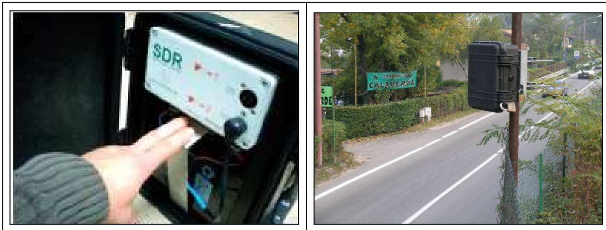
Tali apparecchiature sono dotate di un sensore a microonde basato su un sistema Doppler con frequenza 24,125 GHz a due canali, in grado di rilevare, oltre al transito del veicolo ed alla direzione di marcia, l'istante dell'evento, la lunghezza del mezzo e la sua velocità istantanea; in tal modo è possibile stabilire anche a posteriori quali classificazioni operare sui dati rilevati.
