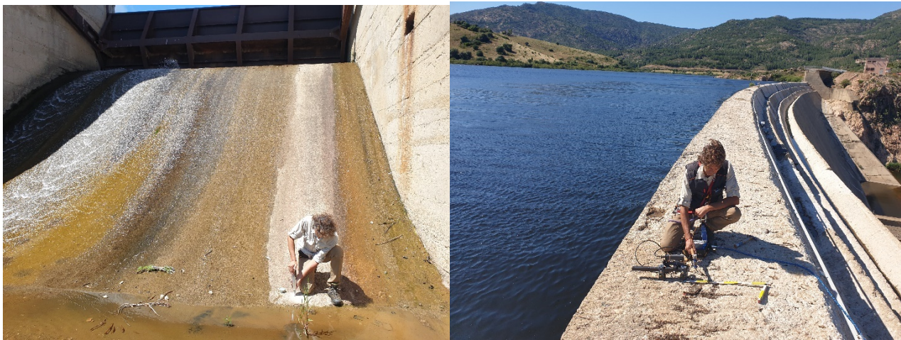
Fig. 4.21 : Indagini con lo sclerometro (a sinistra), indagini SASW (a destra)
