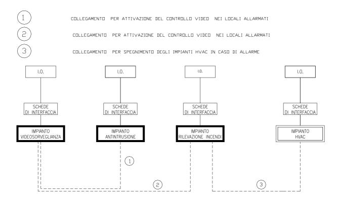
Per il collegamento con il sistema remoto di supervisione la centrale TVCC dovrà essere dotata di apposita interfaccia con il sistema superiore e linguaggio di comunicazione basato su protocolli di comunicazione non proprietari (Mod Bus RTU, Ethernet).
