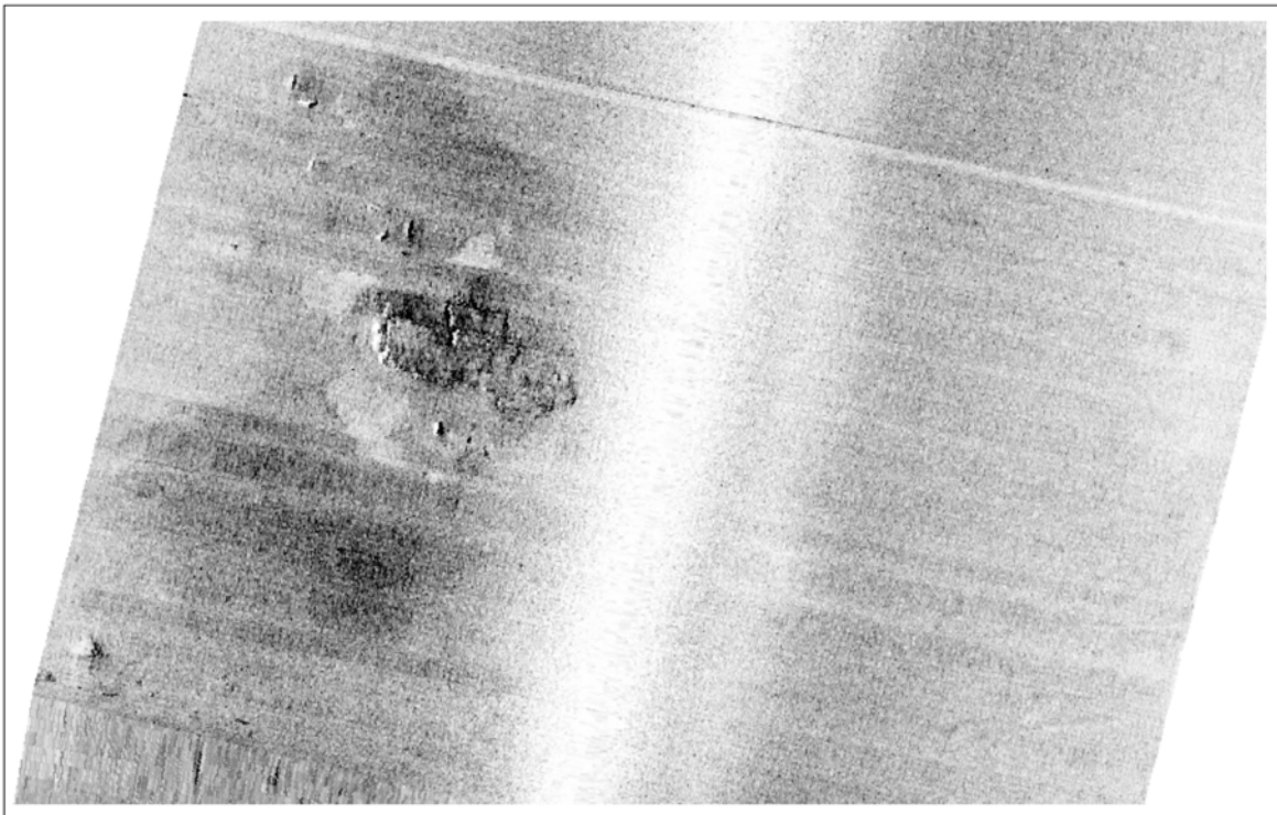
Fig.11. Concrezioni dovute all'ossidazione del gas evidenziate dal rilievo SSS (AM 316).
