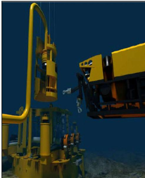
**Figura 3-33: tie-in verticale assistito dal Connector Actuation Tool System**
