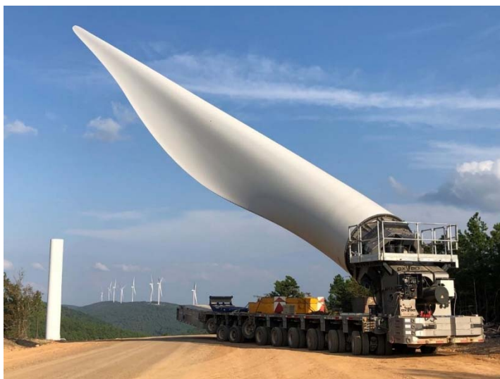
Figura 3 – Trasporto mediante Blade Lifter
