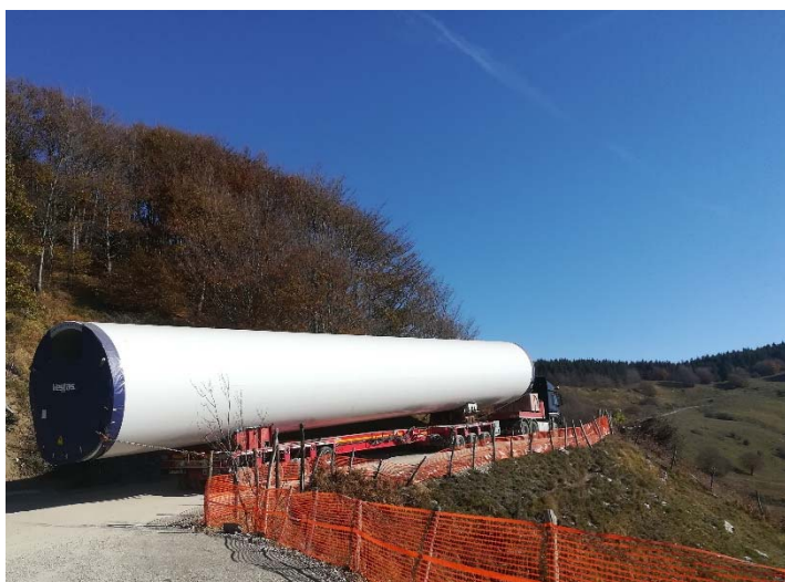
Figura 4 - Trasporto con convoglio semovente
