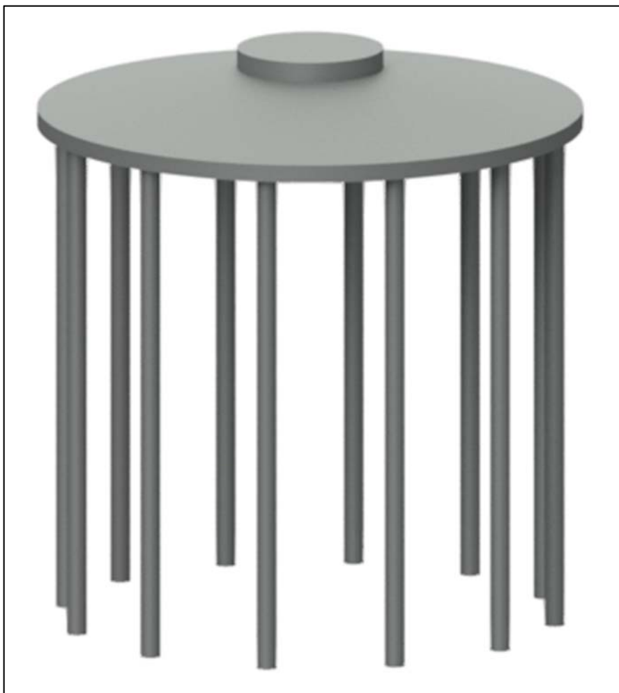
Figura 7: vista tridimensionale della fondazione dell'aerogeneratore
