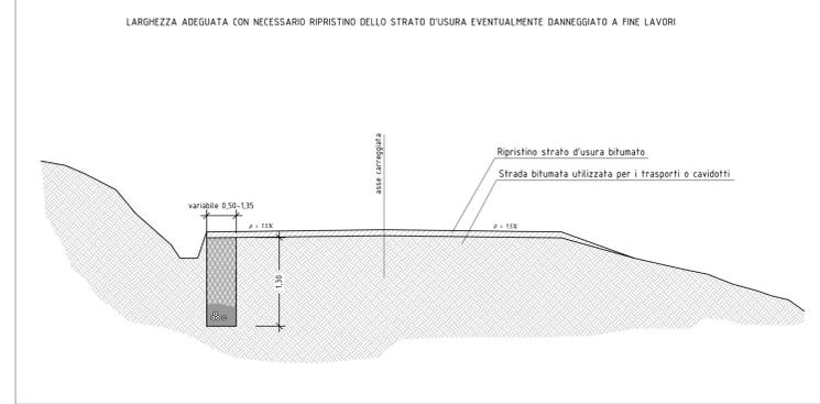
SEZIONI TIPO CON STRADA PREESISTENTE ASFALTATA O STERRATA scala 150
