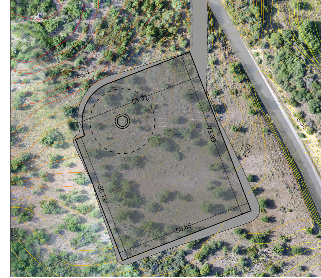
INGOMBRO PIAZZOLA SU FOTO AEREA CON CURVE DI LIVELLO DA RILIEVO - OS 04 - Scala 1:1000
