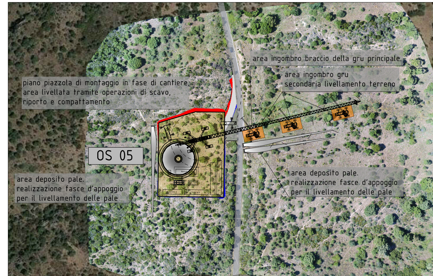
PLANIMETRIA PIAZZOLA - INGOMBRI IN FASE DI MONTAGGIO OS 05 - SCALA 1:2000
