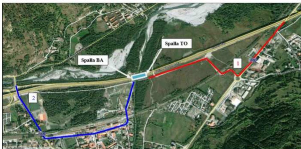
Figura 2 – Viabilità di accesso alle aree di cantiere: piste di cantiere.
