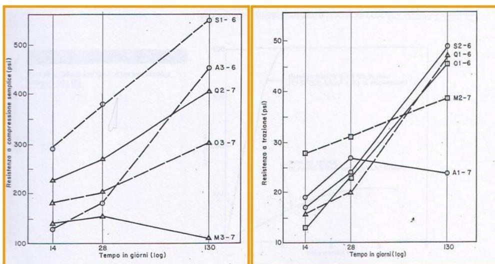
FIGURA 4-37 AUMENTO DELLA RESISTENZA A COMPRESIONE E A TRAZIONE A SEGUITO DELLA MISCELAZIONE CON CALCE
