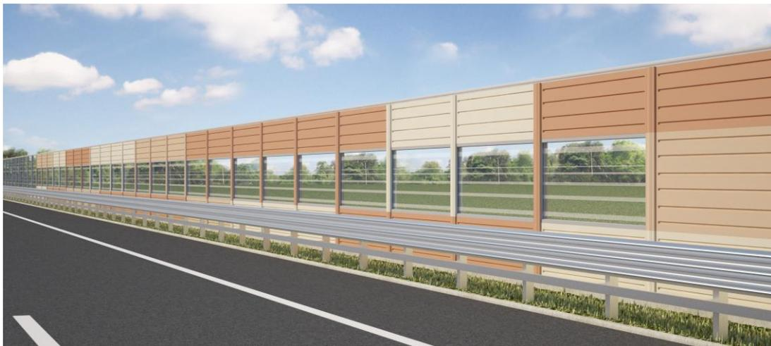
FIGURA 5-5 – BARRIERA ACUSTICA MISTA FONOASSORBENTE-FONOSOLANTE SU RILEVATO – VISTA LATO SORGENTE
