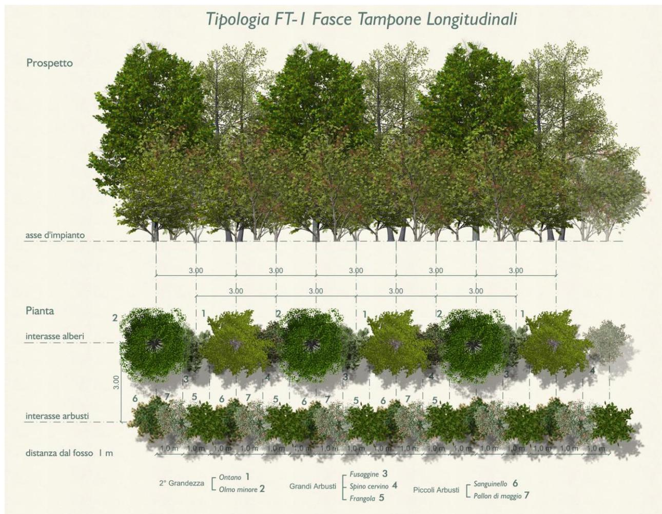
**FIGURA 4-44 - TIPOLOGIA FT1 : FASCE TAMPONE LONGITUDINALI**
