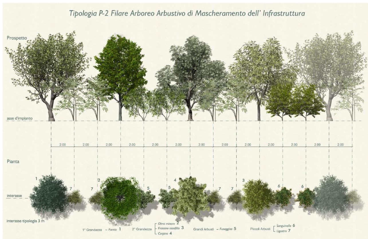
**FIGURA 4-18- TIPOLOGIA P2 : FILARE ARBOREO-ARBUSTIVO DI MASCHERAMENTO DELL'INFRASTRUTTURA**
