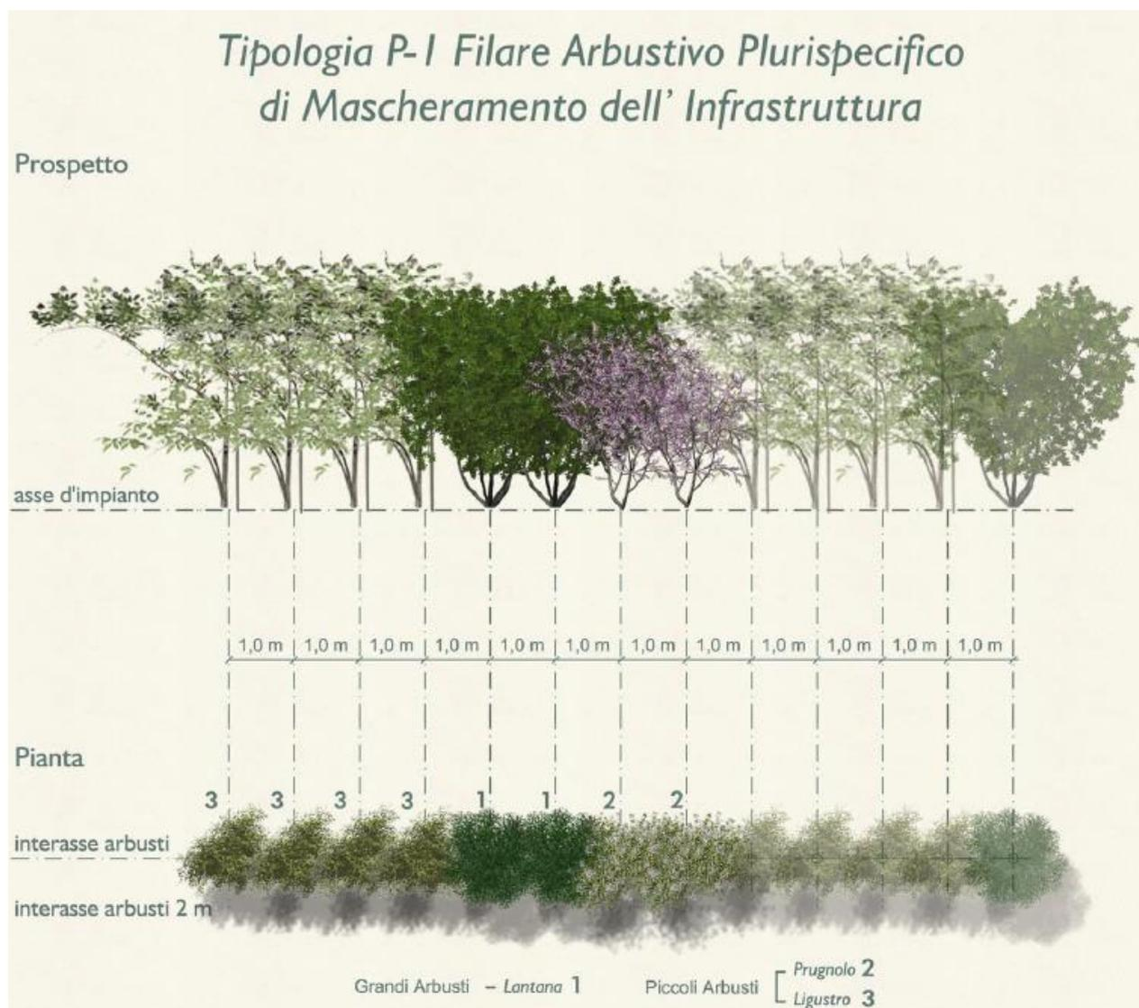
FIGURA 4-17- TIPOLOGIA P1 : FILARE ARBUSTIVO DI MASCHERAMENTO DELL'INFRASTRUTTURA
