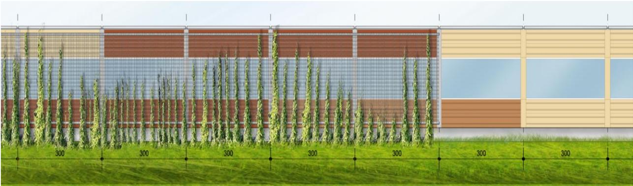
**FIGURA 5-8 – BARRIERA ACUSTICA MISTA FONOASSORBENTE-FONOSOLANTE – PROSPETTO LATO RICETTORE**
