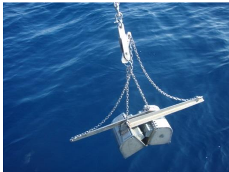
Fig. 2.5 – Benna Van Veen utilizzata per le indagini sulla comunità bentonica.
