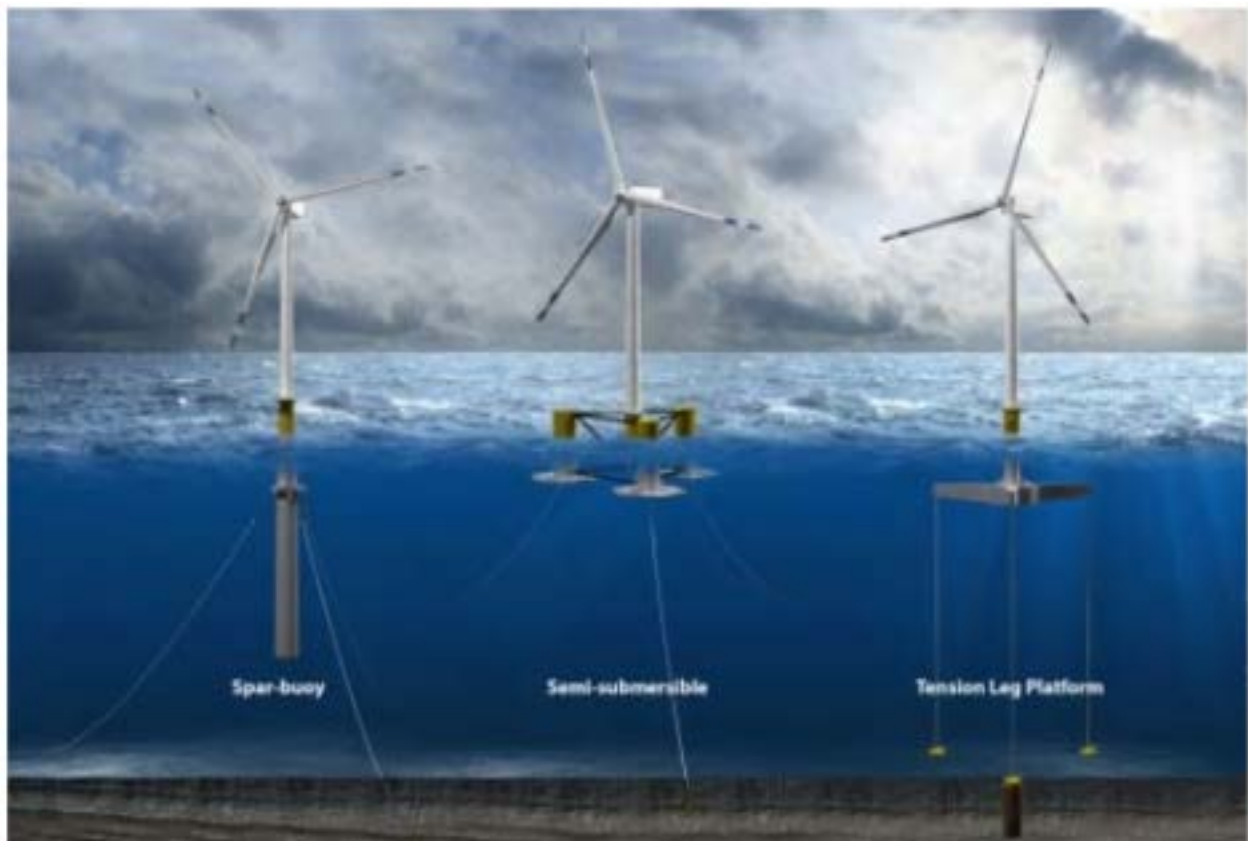
Figura 8: Sistemi di ancoraggio.
