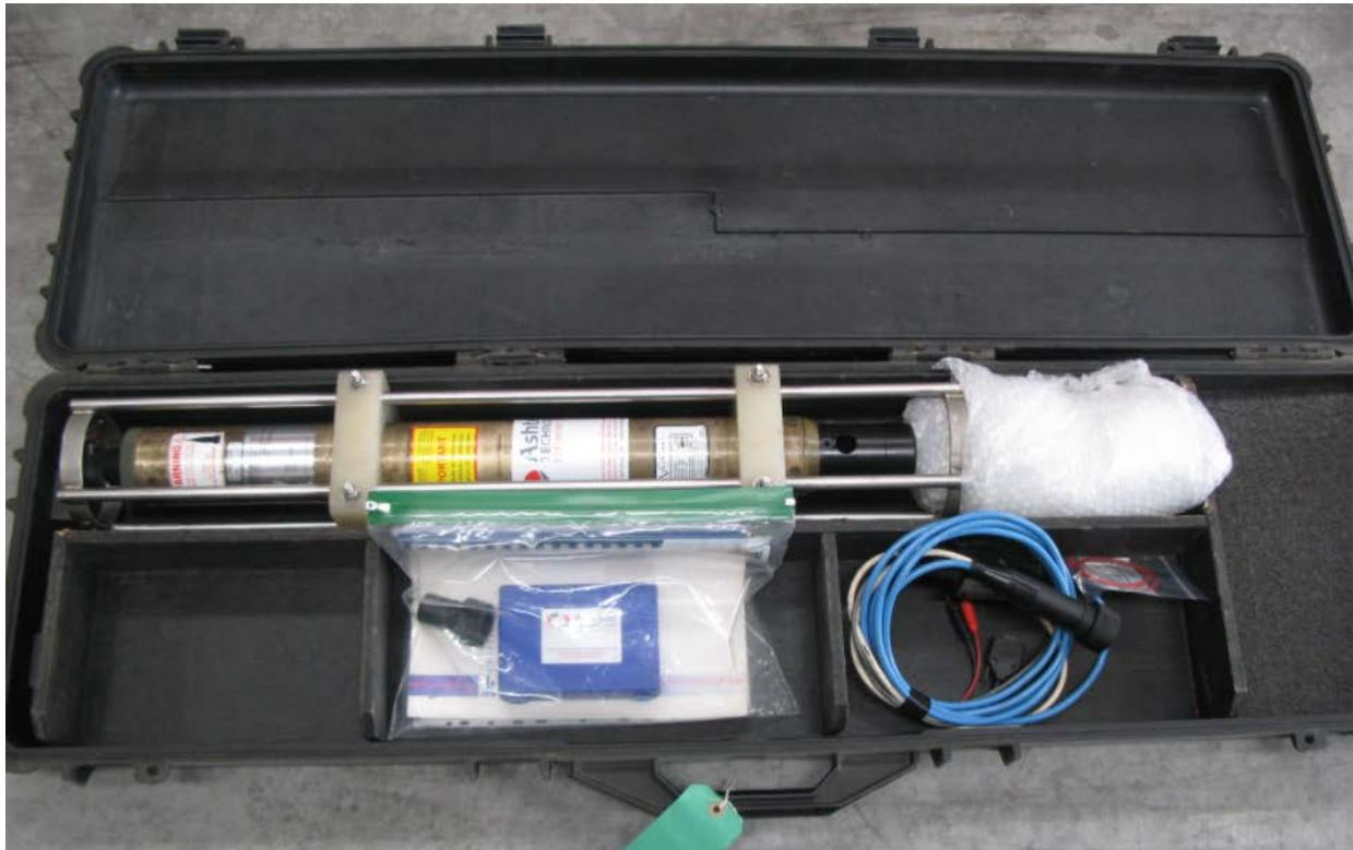
Fig. 4: Sonda multiparametrica (CTD).
