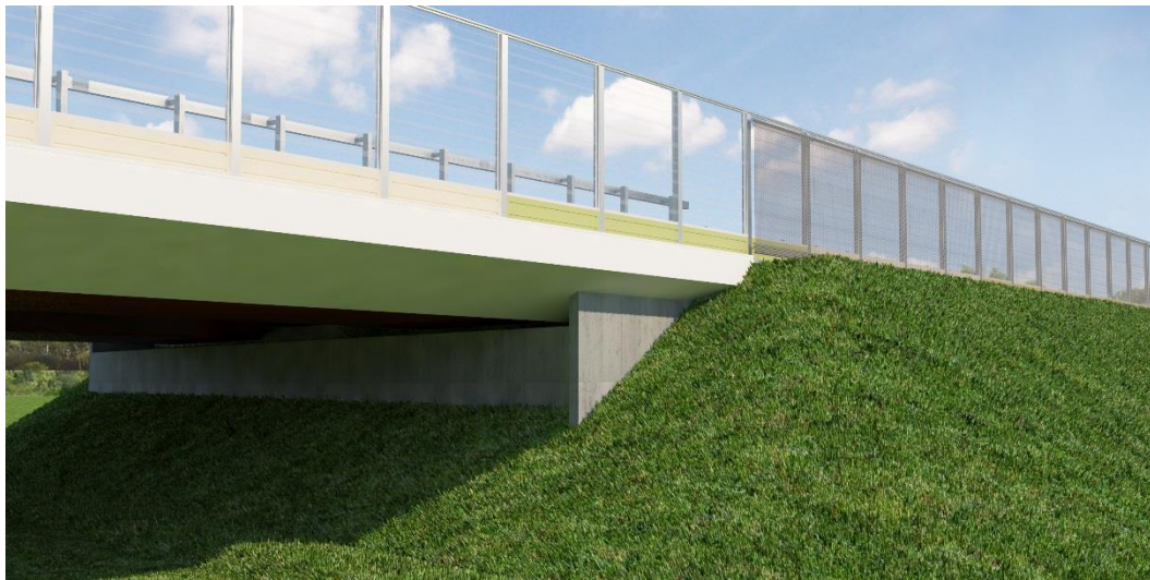
FIGURA 7-12 –TRATTO DI TRANSIZIONE VIADOTTO-RILEVATO
