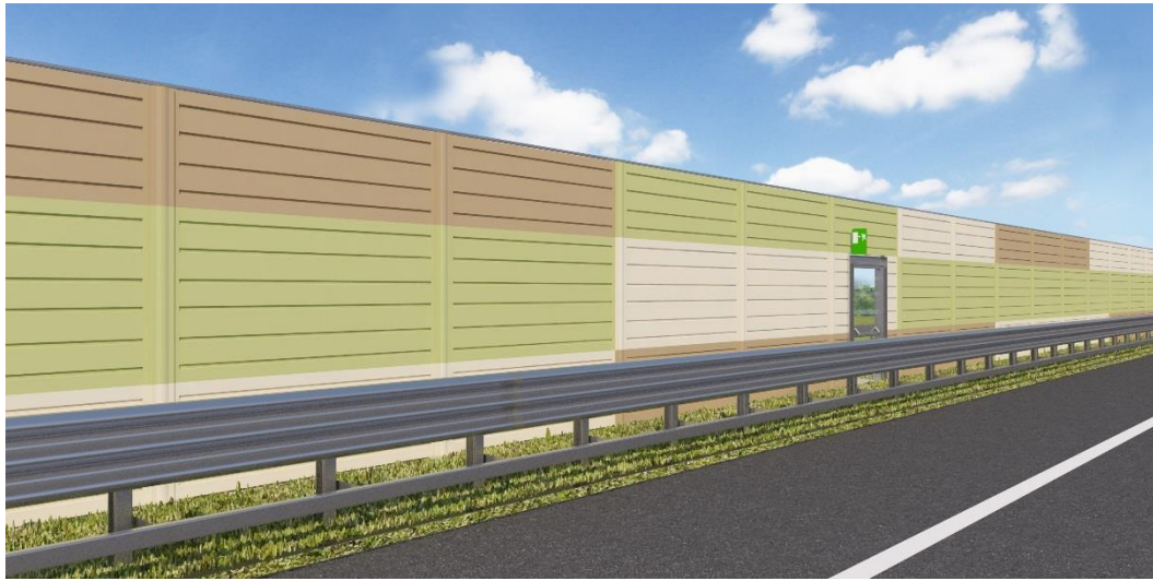
FIGURA 7-17 –SCALA DI SICUREZZA IN CORRISPONDENZA DELLE BARRIERE DI PROTEZIONE ACUSTICA: VISTA LATO SORGENTE
