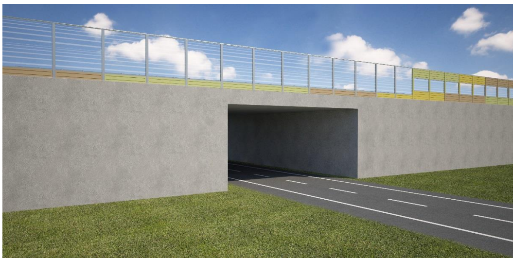
FIGURA 7-13 –TRATTO DI TRANSIZIONE MURO DI SOSTEGNO-SOTTOVIA
