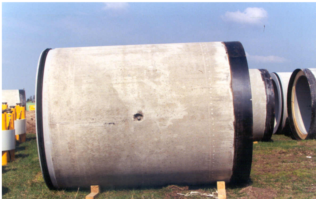
Fig.7: tubo in c.a. (tecnica del microtunnelling)
