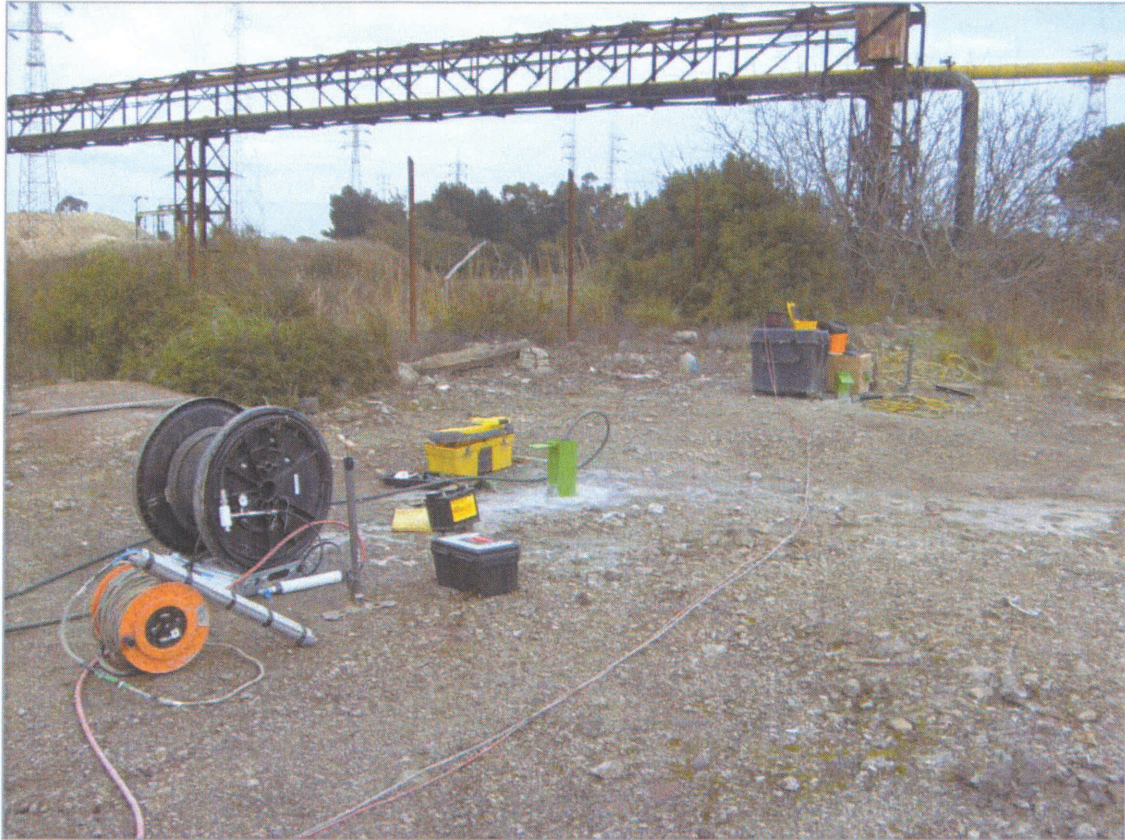
Postazione cross-hole allestita per la misura sismica
