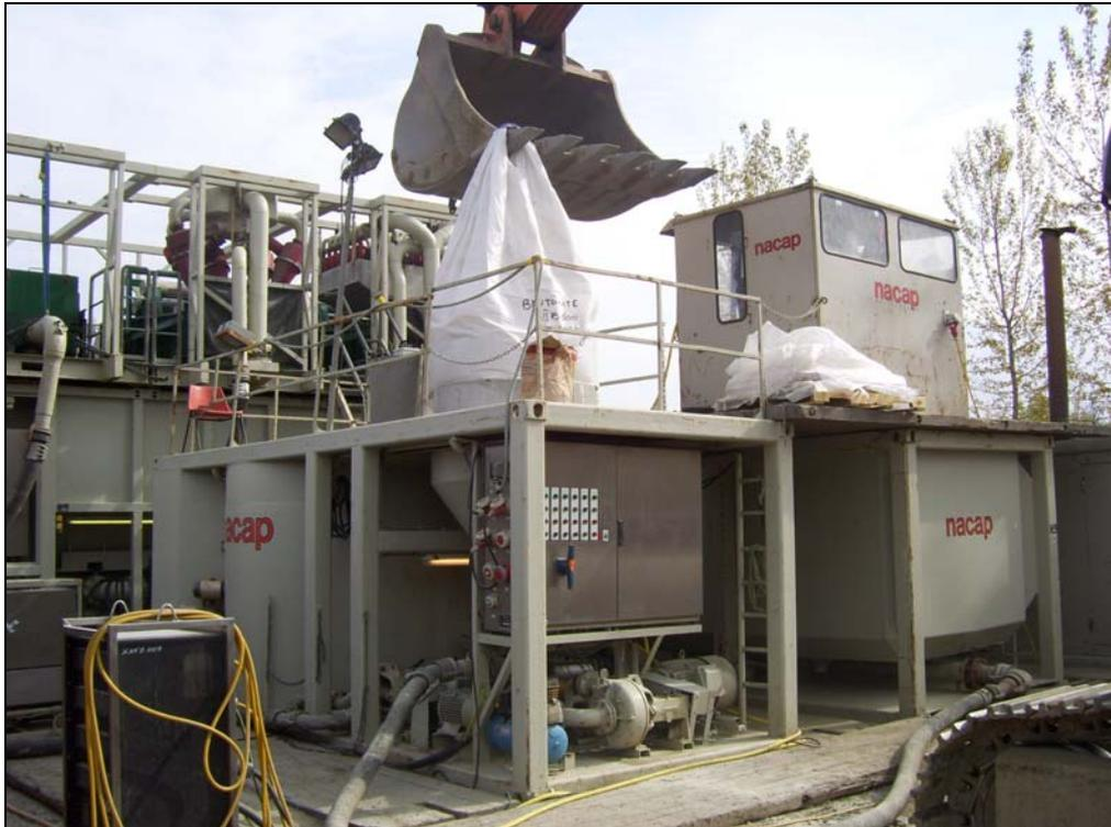
Attraversamento F. Po con met. 30” – Impianto di preparazione dei fanghi di perforazione
