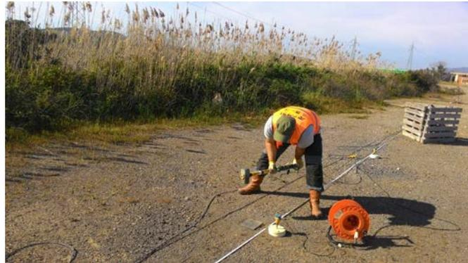
Figura 6 - Fase di acquisizione - Sismica a rifrazione
