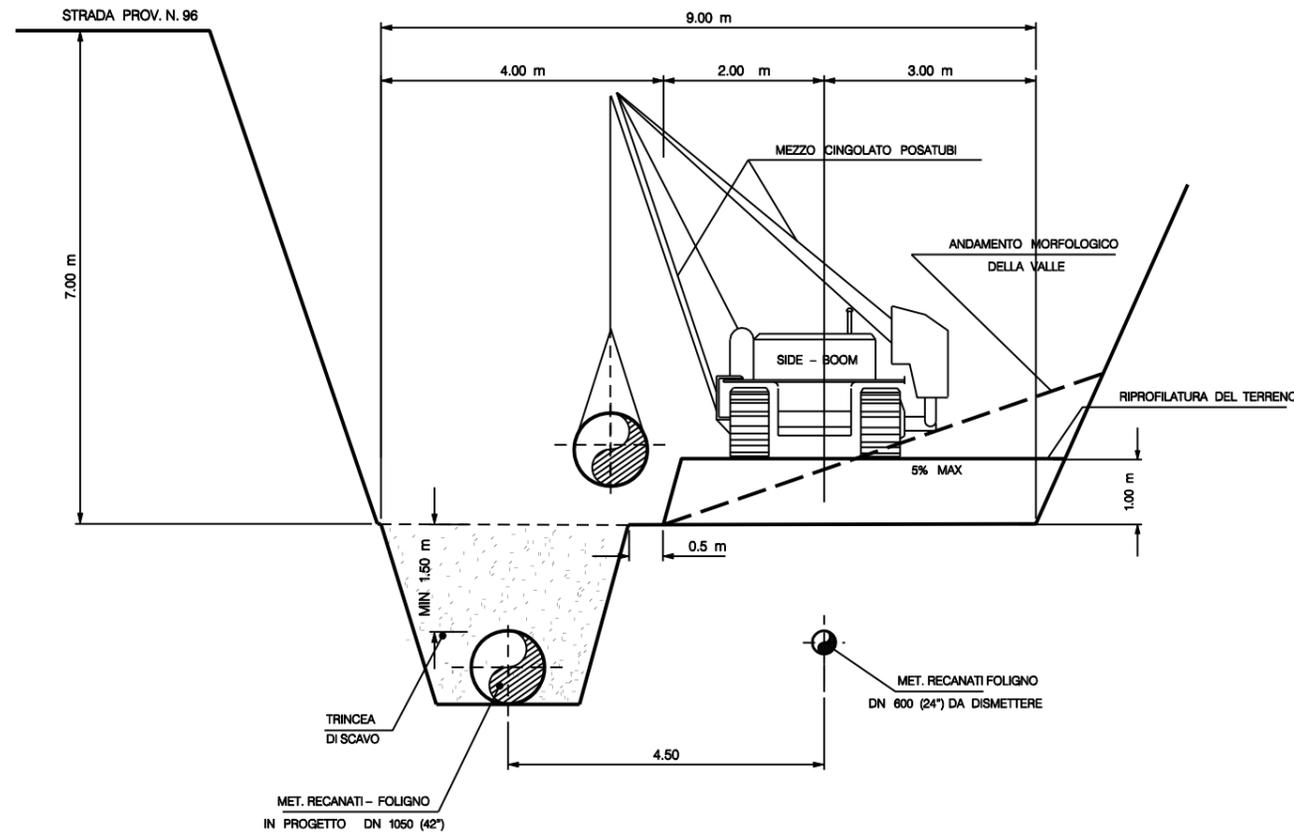
FASE 2 : RIMOZIONE DEL METANODOTTO DN 600 (24")
