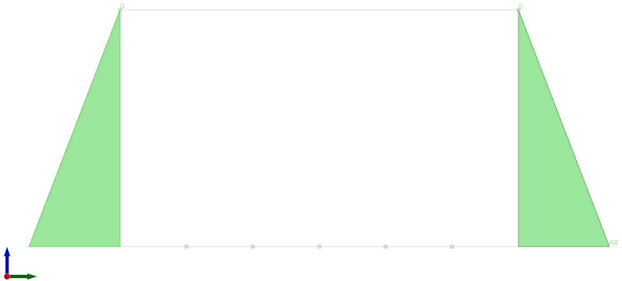
Figura 7 - Condizione spinta terreno A2-M2
