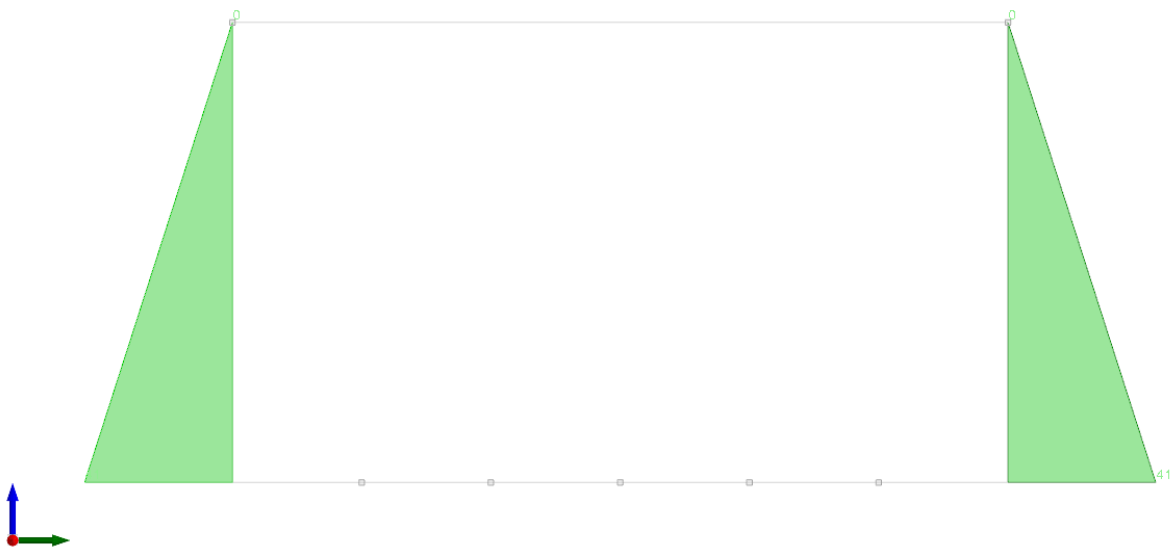
Figura 6 - Condizione spinta terreno A1-M1
