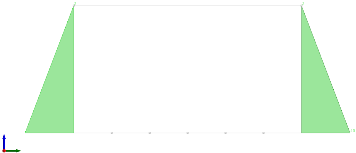
Figura 7 - Condizione spinta terreno A2-M2
