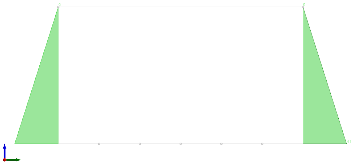
Figura 6 - Condizione spinta terreno A1-M1
