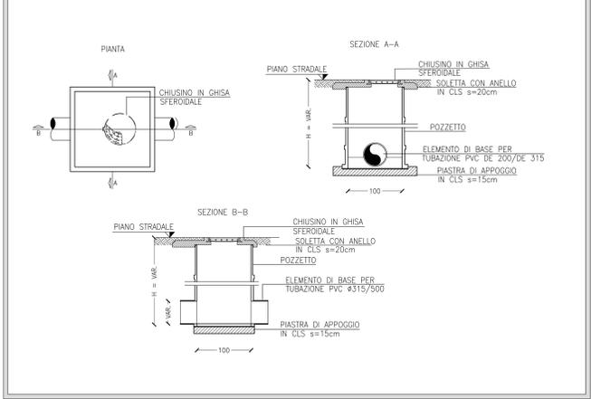
**POZZETTO PREFABBRICATO IN CLS DI ISPEZIONE CON CADITOIA**
