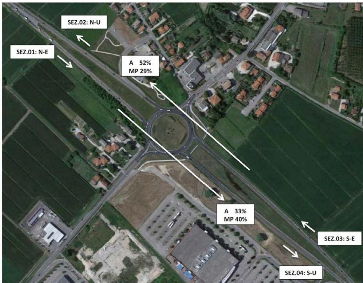
FIGURA 3-7 INDIVIDUAZIONE SEZIONI RILIEVO TRAFFICO DI ATTRAVERSAMENTO
