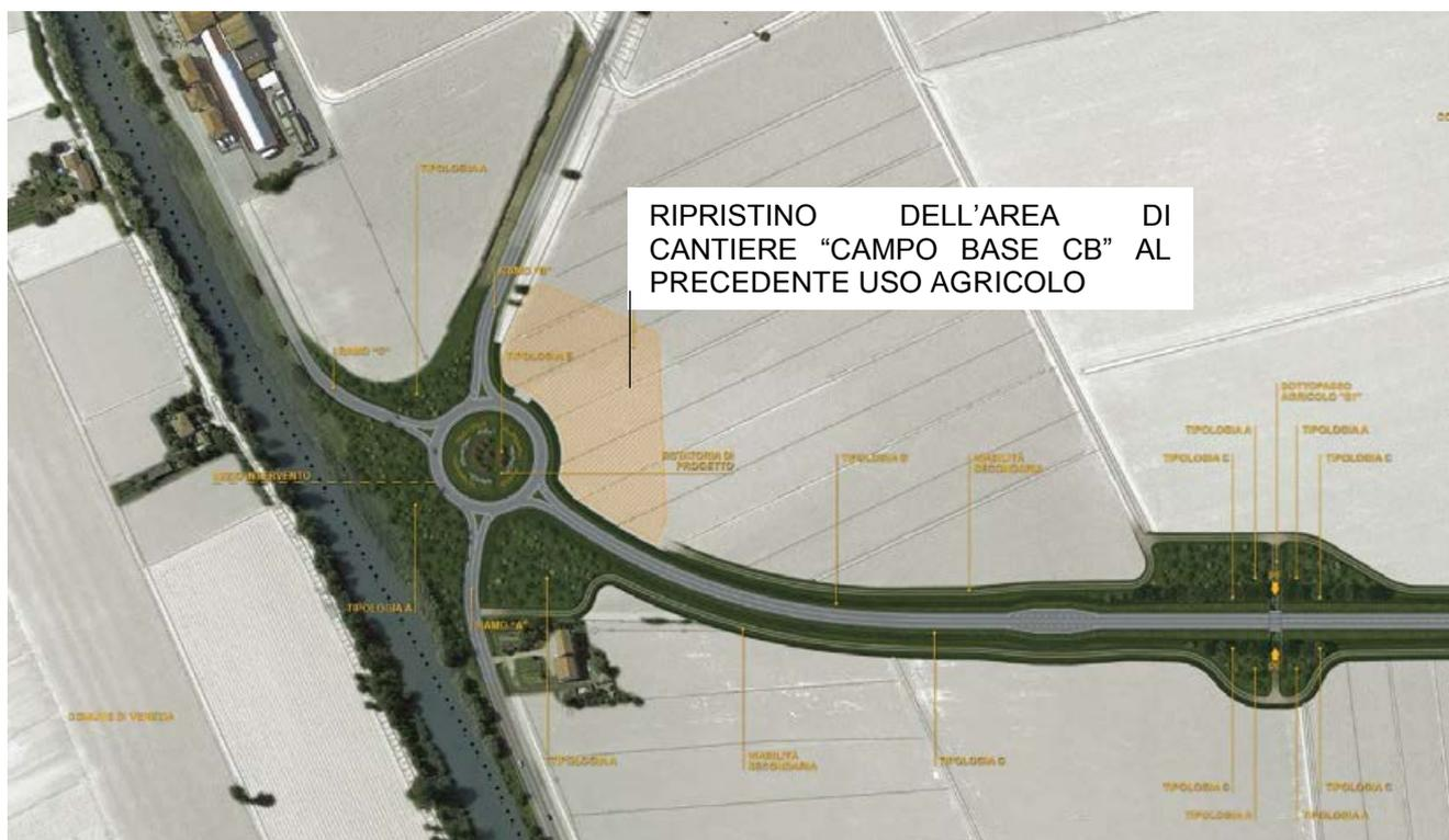
**FIGURA 10-61** ESEMPIO DELL'ATTIVITÀ DI RIPRISTINO DELL'AREA DI CANTIERE CB
