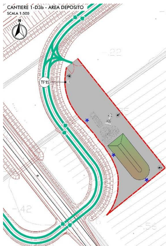
FIGURA 4-19 LAY-OUT FUNZIONALE DEL CANTIERE 1-D3A ED 1-D3B DURANTE LA SECONDA CONFIGURAZIONE DI CANTIERE (ESTRATTO DALL'ELAB. T00IA10CANLF01)
