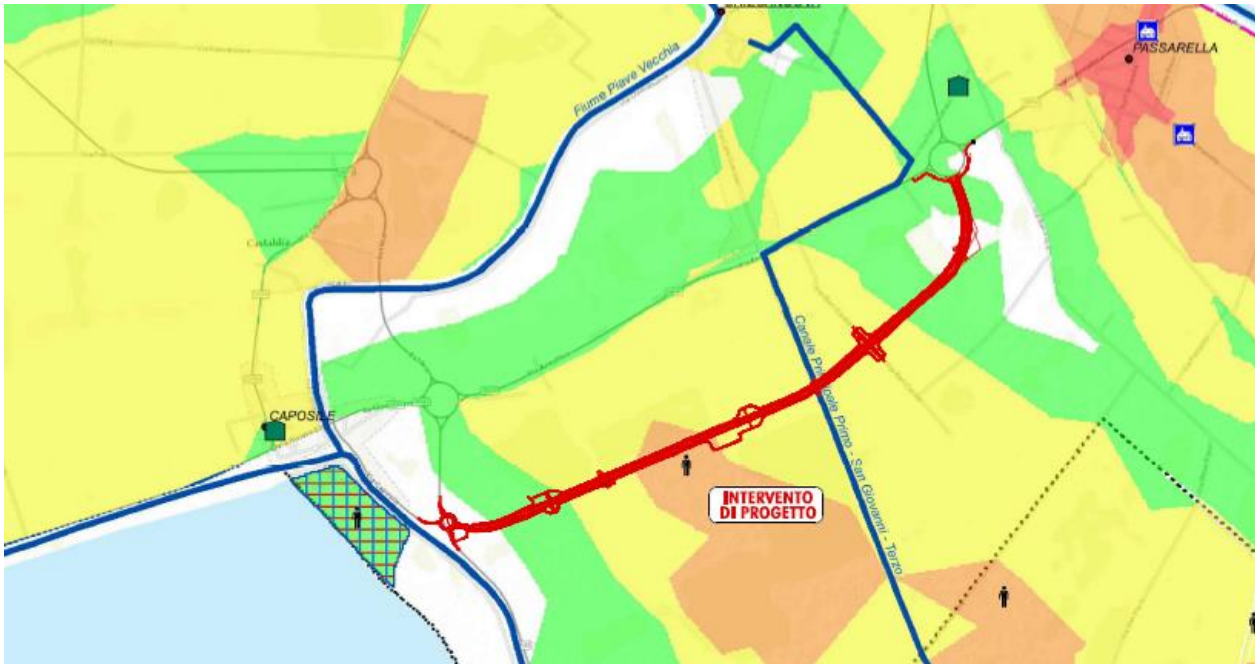
FIGURA 2-3 STRALCIO DELLA CARTA DELLE AREE ALLAGABILI – ALTEZZE IDRICHE PER TR=100ANNI (FONTE PGRA DEL DISTRETTO IDROGRAFICO DELLE ALPI ORIENTALI) – INTERVENTO LOCALITÀ ARMELLINA
