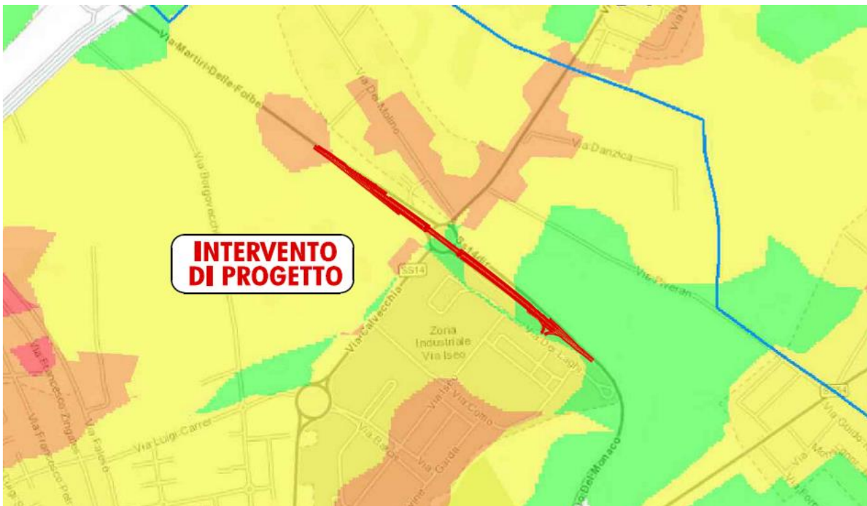
FIGURA 2-4 STRALCIO DELLA CARTA DELLE AREE ALLAGABILI – ALTEZZE IDRICHE PER TR=100ANNI (FONTE PGRA DEL DISTRETTO IDROGRAFICO DELLE ALPI ORIENTALI) – INTERVENTO LOCALITÀ CALVECCHIA
