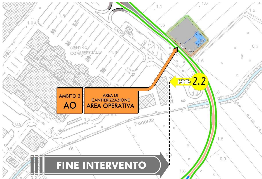
FIGURA 2-37 INQUADRAMENTO TERRITORIALE DELL'AREA DI CANTIERE AO CON INDICAZIONE DEL SISTEMA DI ACCESSO (ESTRATTO DALL'ELABORATO T00CA00CANPL02)
