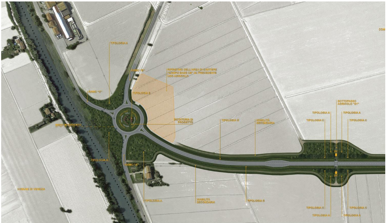
FIGURA 2-47 ESEMPIO DELL'ATTIVITÀ DI RIPRISTINO DELL'AREA DI CANTIERE CB (ESTRATTO DALL'ELABORATO T00CA00CANLF01)
