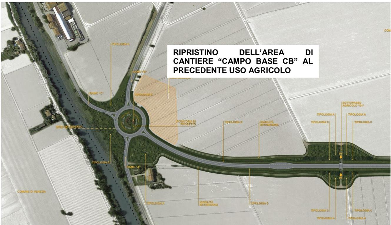
**FIGURA 5-1 ESEMPIO DELL'ATTIVITÀ DI RIPRISTINO DELL'AREA DI CANTIERE CB
