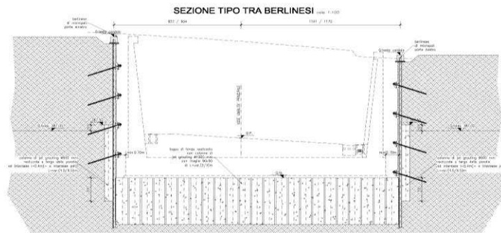
Trincea protetta da muri tra micropali
