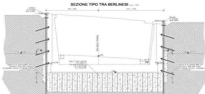
Figura 4.1.1.3 Trincea protetta da muri tra micropali tirantati
